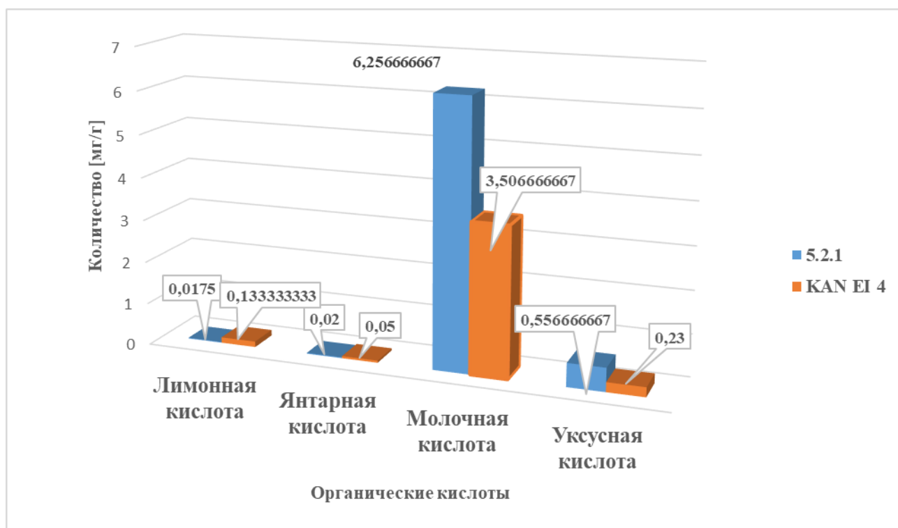
Рисунок 6 - Результаты анализа органических кислот методом высокоэффективной жидкостной хроматографии (ВЭЖХ)
