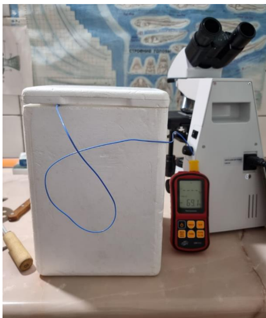
Рисунок 51 – Выдерживание проб в азоте с отслеживанием скорости заморозки с помощью низкотемпературного датчика [248]
