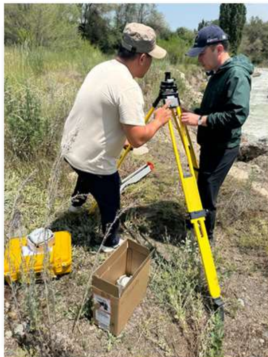
Сурет 13 – Зерттеу аумағында геодезиялық желісін құру және далалық түсіріс жүргізу көрінісі (South Galaxy G3 (IMU))
