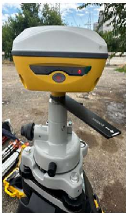
Сурет 13 – Зерттеу аумағында геодезиялық желісін құру және далалық түсіріс жүргізу көрінісі (South Galaxy G3 (IMU))
