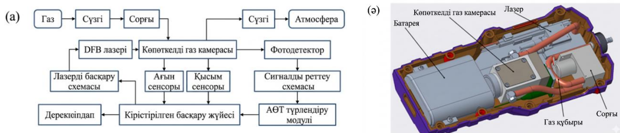
Сурет 2.1 - (а) Детектордың жалпы блок-схемасы (ә) Нақты өнімнің құрылымдық диаграммасы [64]
