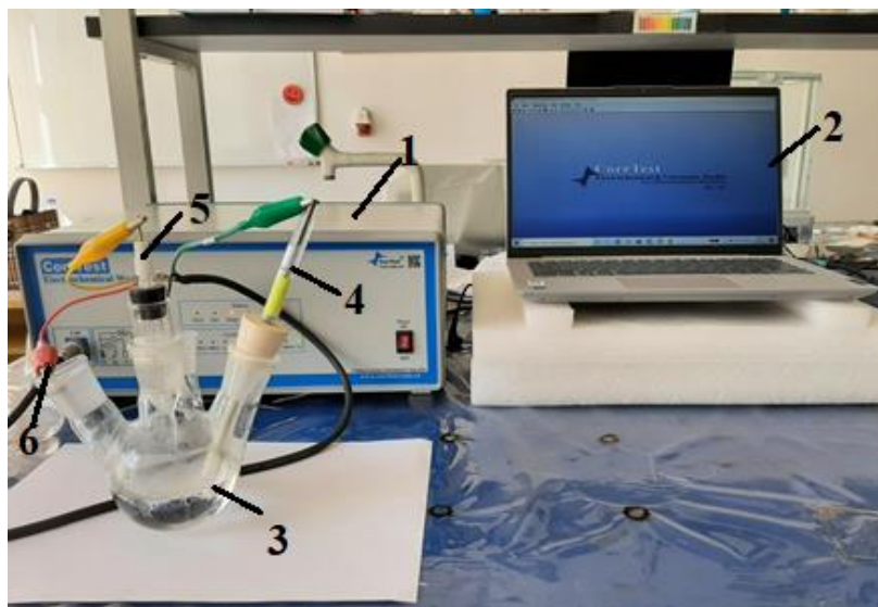
Сурет 2.5 – CS 120 потенциостат-гальваностаты: 1 – потенциостат; 2 – ноутбук Lenovo V14-IGL; 3 – электрохимиялық ұяшық; 4 – жұмысшы электрод (зерттелетін металл); 5 – салыстырмалы электрод (хлор-күміс); 6 – көмекші электрод (платина)
