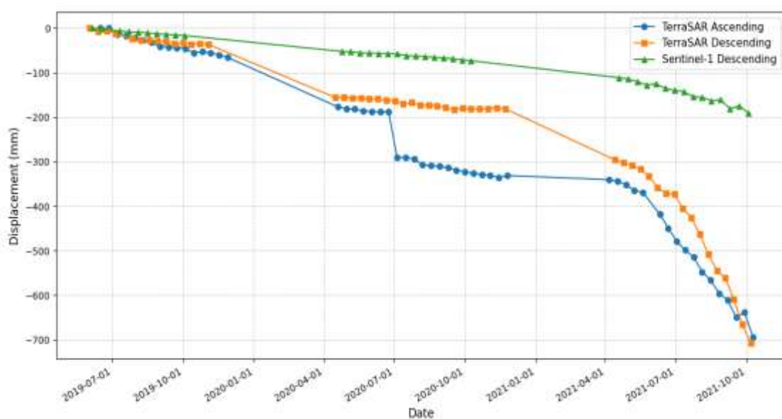
Рисунок 48 – График временных рядов амплитуд смещения LOS на угольной шахте «Саранская» (лава 13), полученный по данным TerraSAR-X и Sentinel-1
