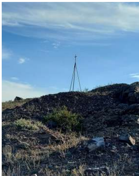
Рисунок 57 – Пункт геодезической привязки «Тригопункт»
