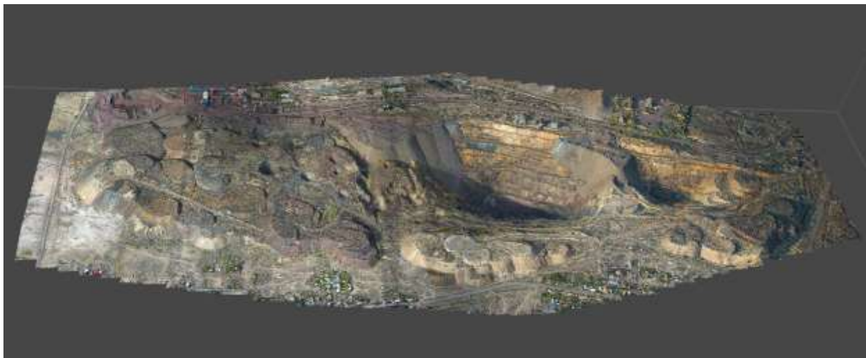
Рисунок 72 – Тайловая модель дневной поверхности в зоне воздействия взрывных работ в пределах горного отвода
