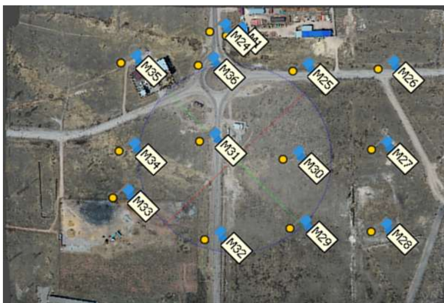
Рисунок 10 – Наземная опорная сеть контрольных точек
