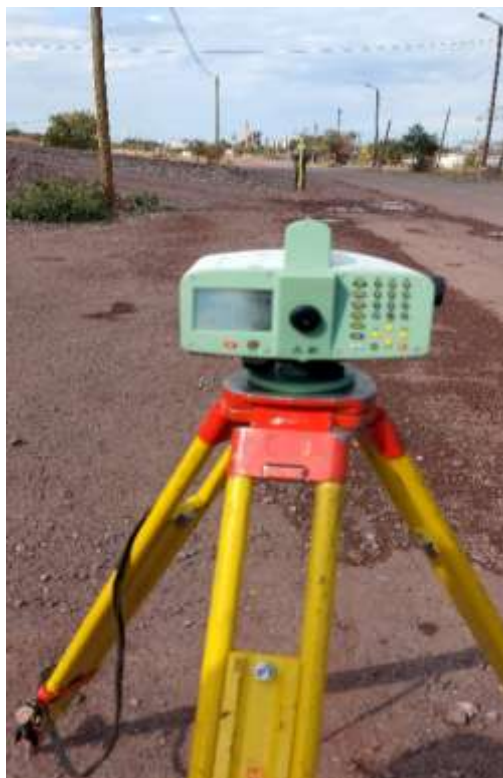
Рисунок 61 – Снятие отчета нивелирования по передней рейке
