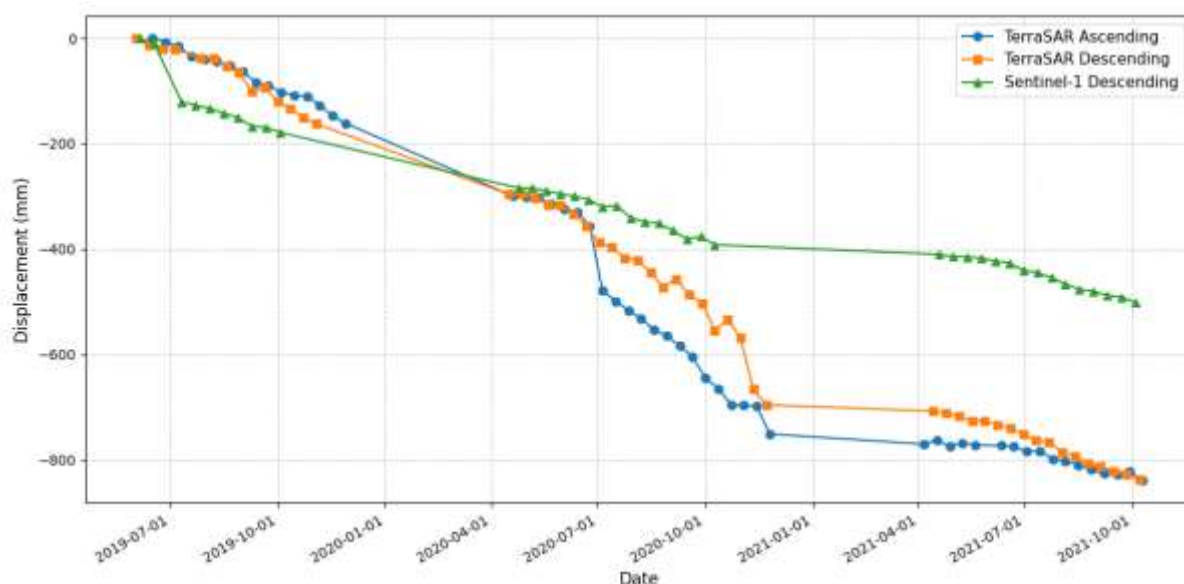
Рисунок 45 – График временных рядов амплитуд смещения LOS в угольном разрезе Кузембаева (лава 7), полученный на основе данных TerraSAR-X и Sentinel-1
