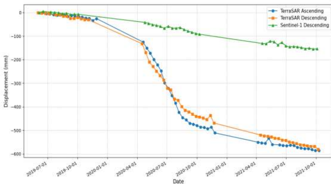
Рисунок 42 – График временных рядов амплитуд смещения LOS в угольной шахте Костенко (лава 3), полученный по данным TerraSAR-X и Sentinel-1
