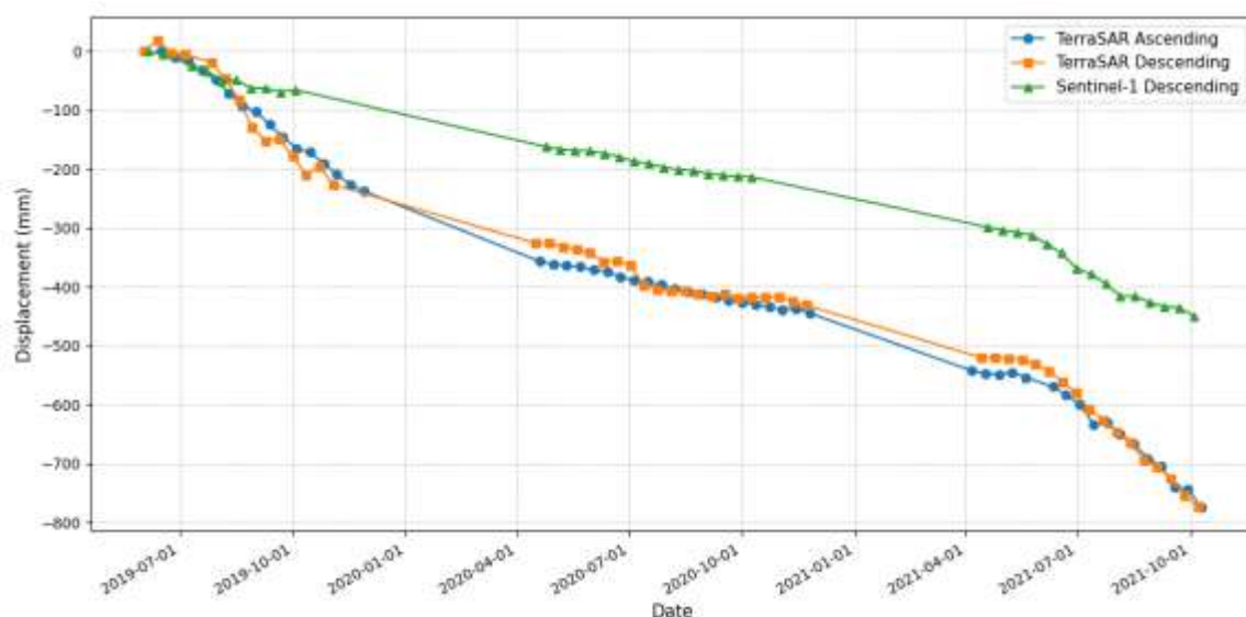
Рисунок 46 – График временных рядов амплитуд смещения LOS в угольном разрезе Кузембаева (лава 9), полученный на основе данных TerraSAR-X и Sentinel-1
