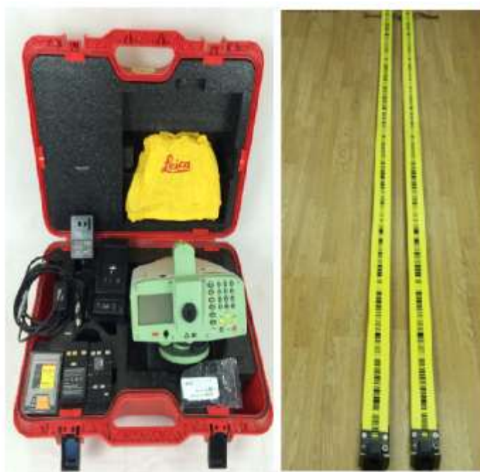
Рисунок 59 - Комплект Leica DNA03 для высокоточного нивелирования
