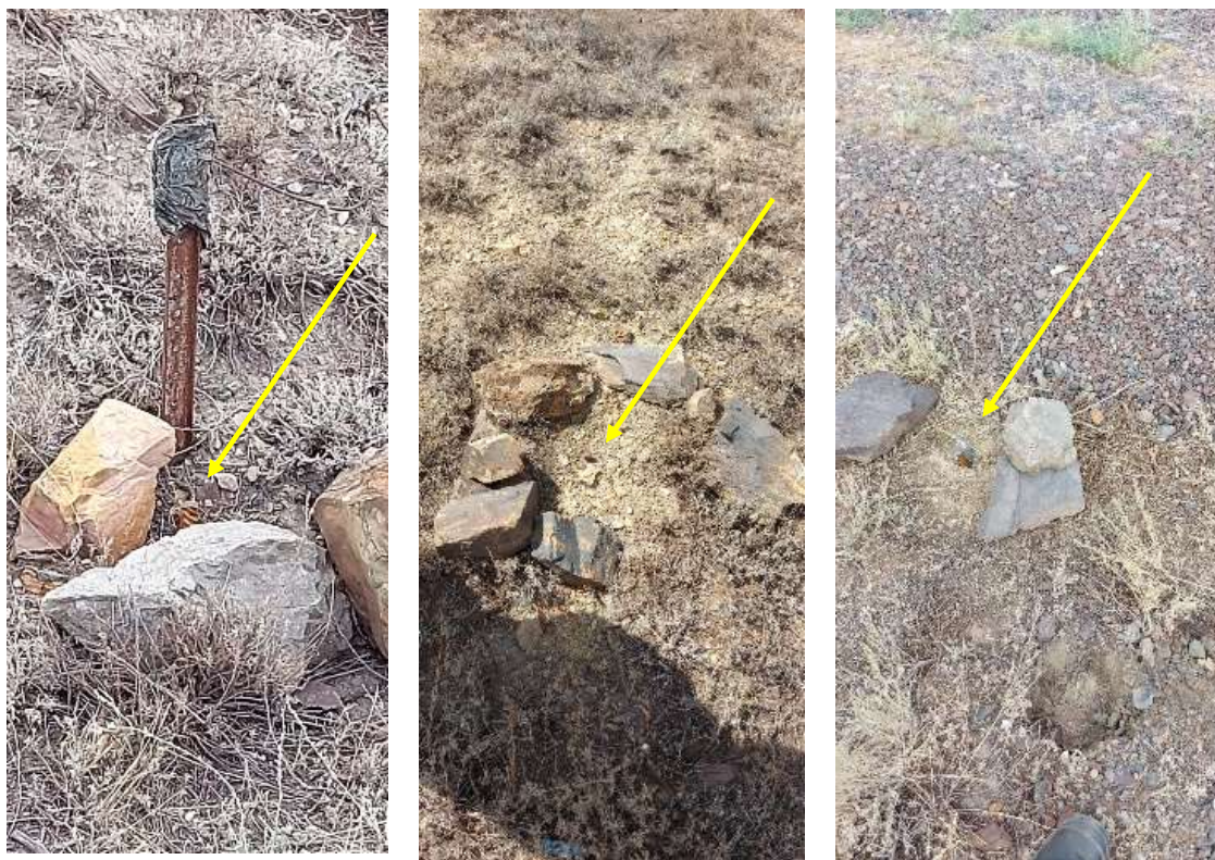
Рисунок 53 – Вид закрепленных грунтовых реперов
