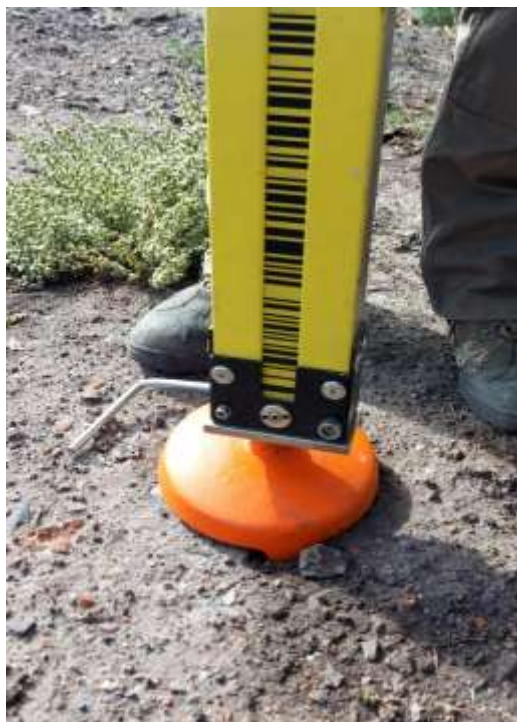
Рисунок 60 – Геодезический башмак на промежуточной точке
