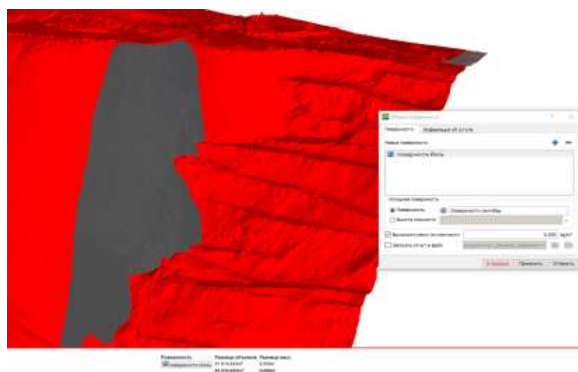
Рисунок 87 – Расчет объема засыпки карьера за период с 26.07.2023г. по 18.09.2023г.
