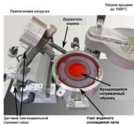
а) общий вид; б) описание трибометрической установки с нагреваемым вращающимся образцом
