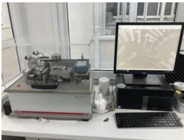
Рисунок 2.5 – Трибометр TRB 3 Anton Paar с профилометром SURTRONIC S-100
